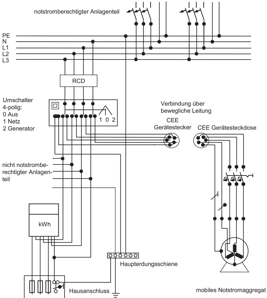
Anlage nur teilweise notstromberechtigt. Der notstromberechtigte Anlagenteil wird als TN-S-System betrieben (siehe Abschnitt 5 Erläuterungen).
