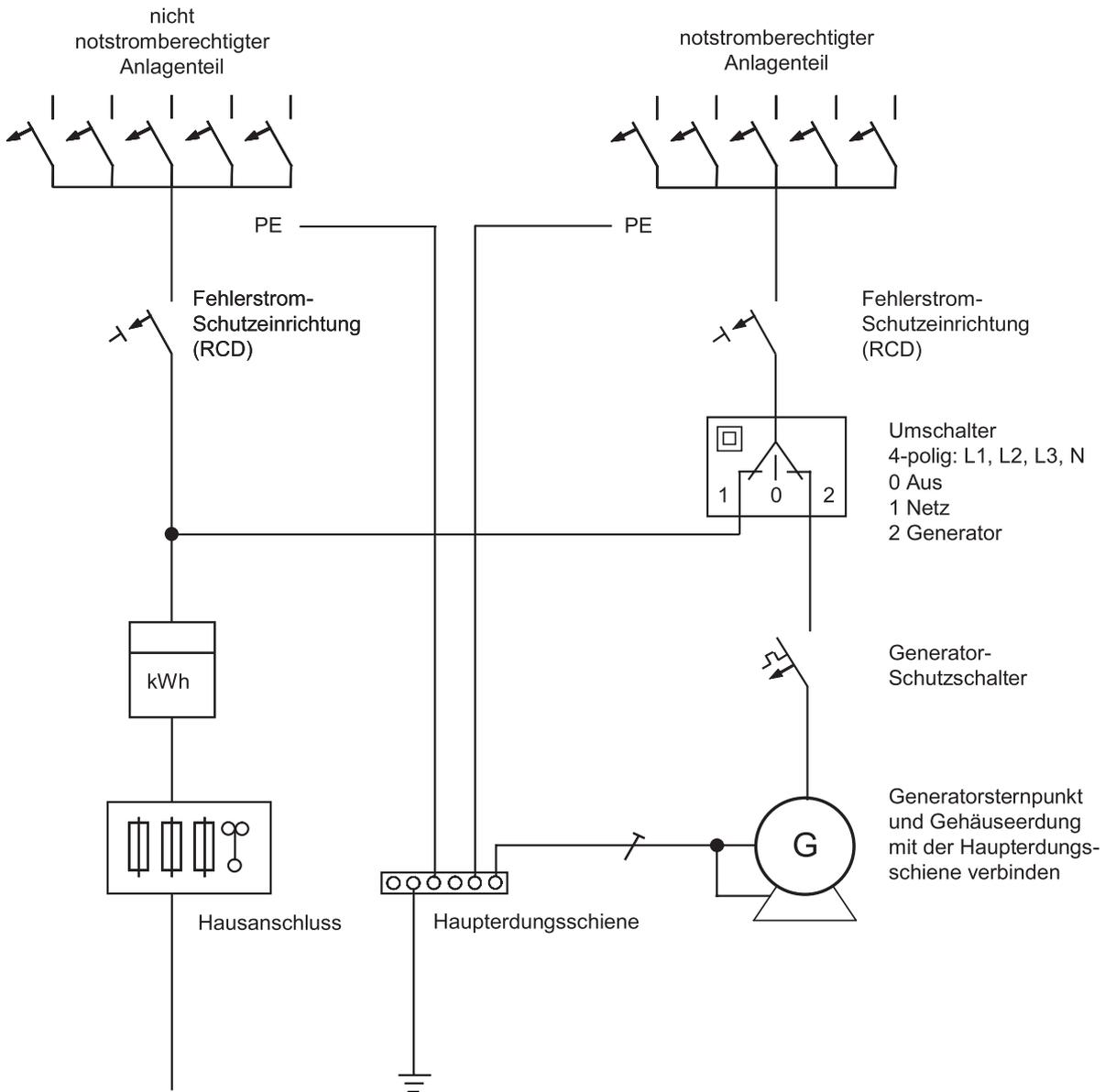
Anlage nur teilweise notstromberechtigt. Der notstromberechtigte Anlagenteil wird während des Generatorbetriebes als TN-S-System mit Schutz durch automatische Abschaltung betrieben (keine Trennung von Anlagen- und Betriebserder möglich).
