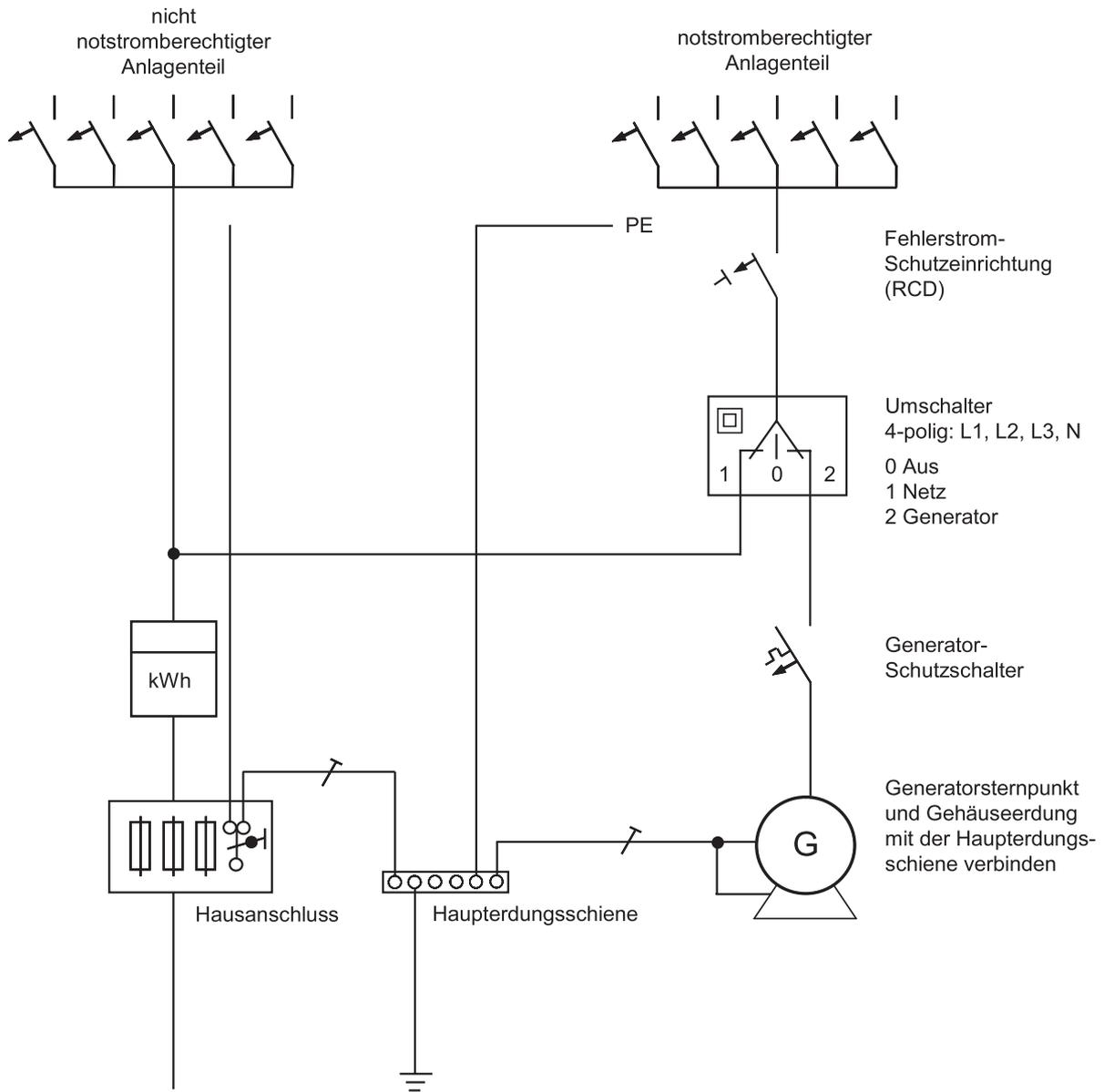
Anlage nur teilweise notstromberechtig. Der notstromberechtigter Anlagenteil wird als TN-S-System betrieben (siehe Abschnitt 5 Erläuterungen).
