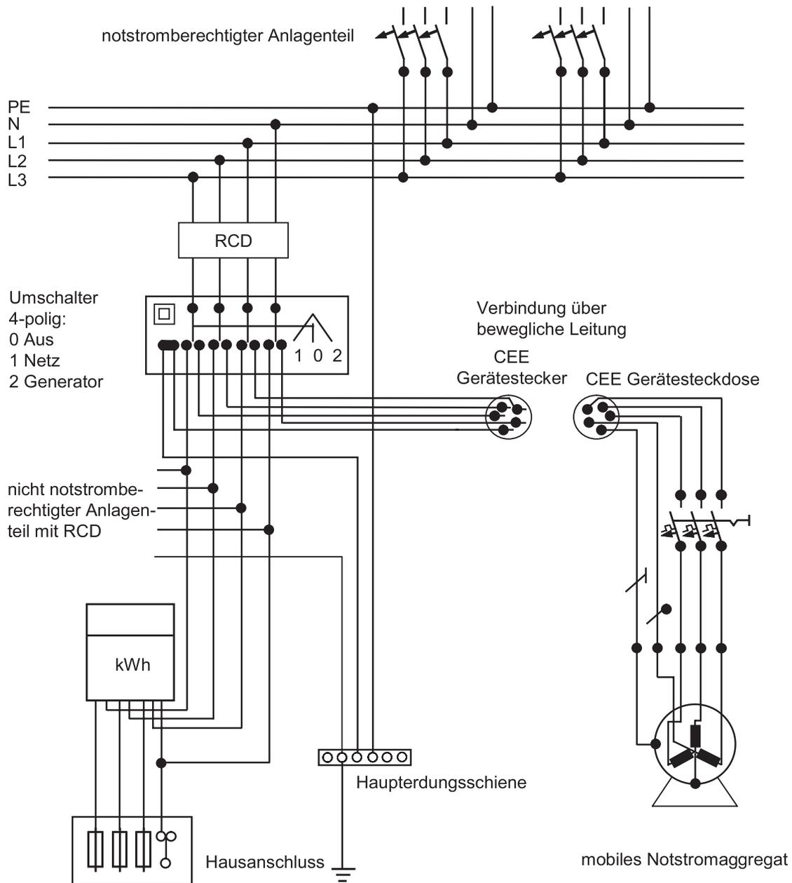
Anlage nur teilweise notstromberechtigt. Der notstromberechtigter Anlagenteil wird während des Generatorbetriebes als TN-S-System mit Schutz durch automatische Abschaltung betrieben (keine Trennung von Anlagen- und Betriebserder möglich).
